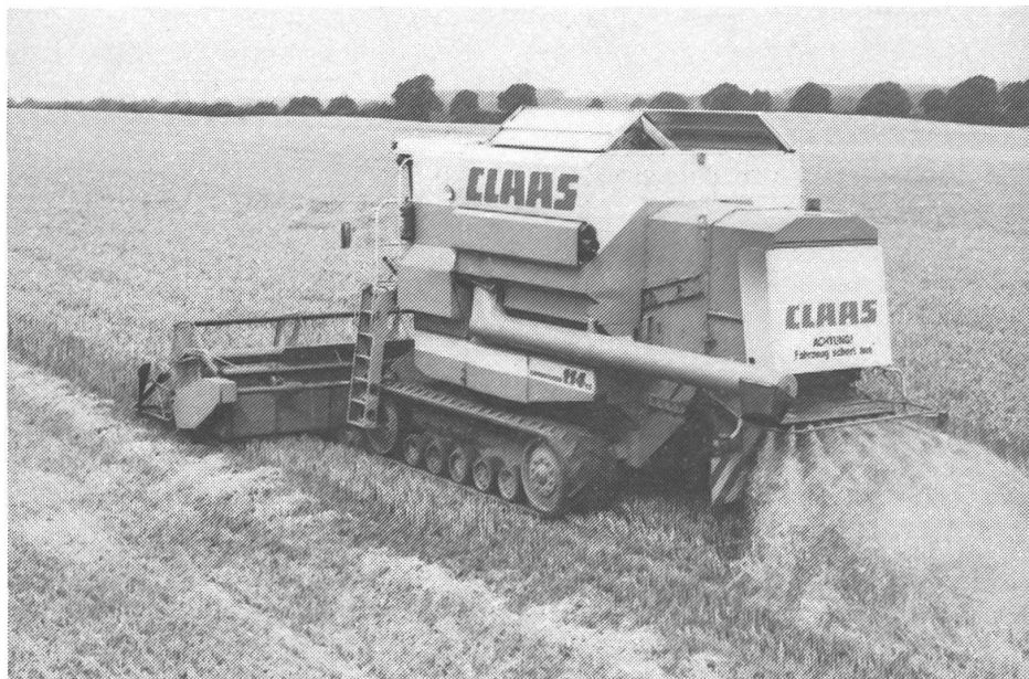
Equipée du système à chenilles en caoutchouc mis au point par Caterpillar, la batteuse Claas a intéressé beaucoup de visiteurs.
