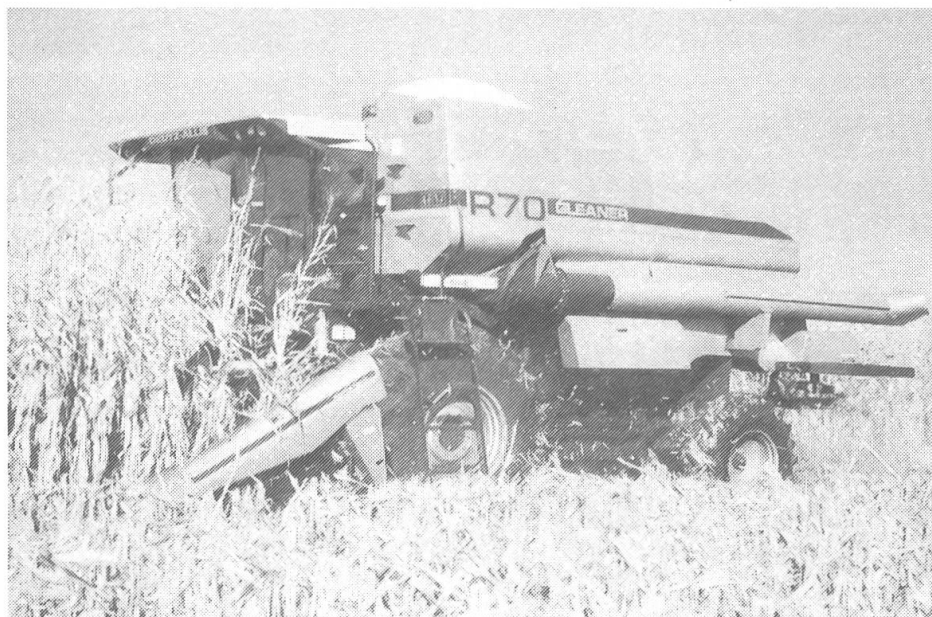
La batteuse sans secoueurs Gleaner R70 de Deutz-Allis qui, par sa conception originale et son revêtement caractéristique en tôle galvanisée, ne passe pas inaperçue.
