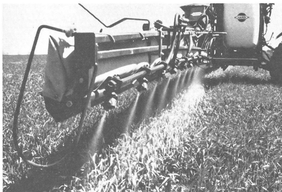
Le brouillard de pulvérisation, grâce à une soufflerie, est propulsé au sol par un manchon gonflable en matière synthétique.
