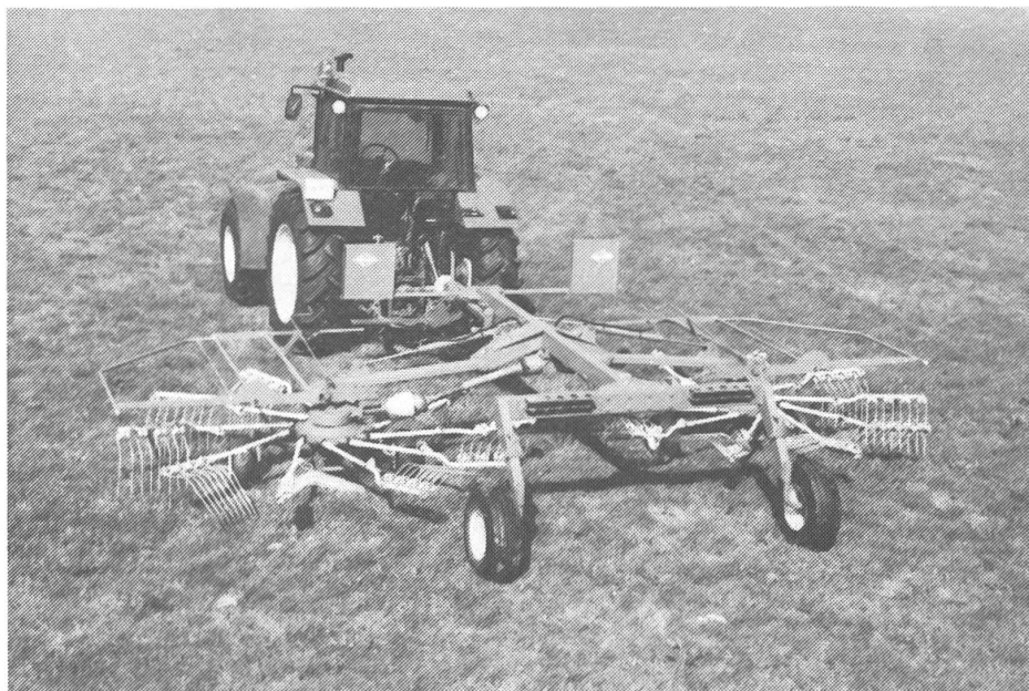
Des gros andaineurs avec plan de travail de 6 mètres et plus représentent la nouvelle vague des machines de fenaion.
