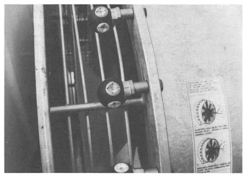
Des buses pivotantes multiples permettent de changer rapidement de type de buses et de grandeur.
