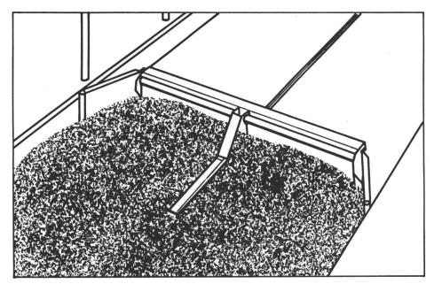
Fig. 8: Cette solution de compromis n'exige pas de chemin pour atteindre la position de travail et offre donc les avantages aussi bien du tiroir-convoyeur repliant que du tiroir-convoyeur articulé horizontalement.
