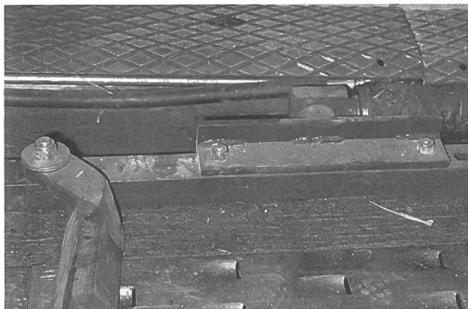
Fig. 1: Barre de poussée commandée par système hydraulique (piston de pression en haut, à droite). La canalisation de drainage est recouverte de plaques perforées.
