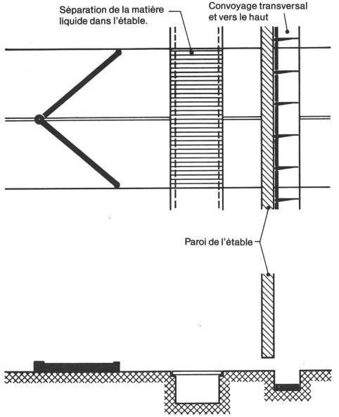
Fig. 9: Possibilité de séparer le lisier et le fumier.
