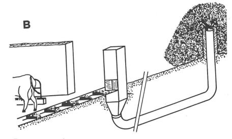
Fig. 4: Evacuateur, système «taupe»: A Installation horizontale; la sortie du côté de la fumière se situe au niveau du sol. B Installation verticale; la sortie du côté de la fumière est élevée.
