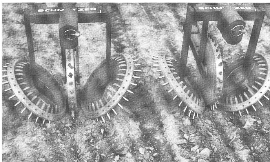
Élément Schmotzer. Aucune croûte ne résiste au travail intensif de cette machine. Intervention nécessaire avant la levée des betteraves.
