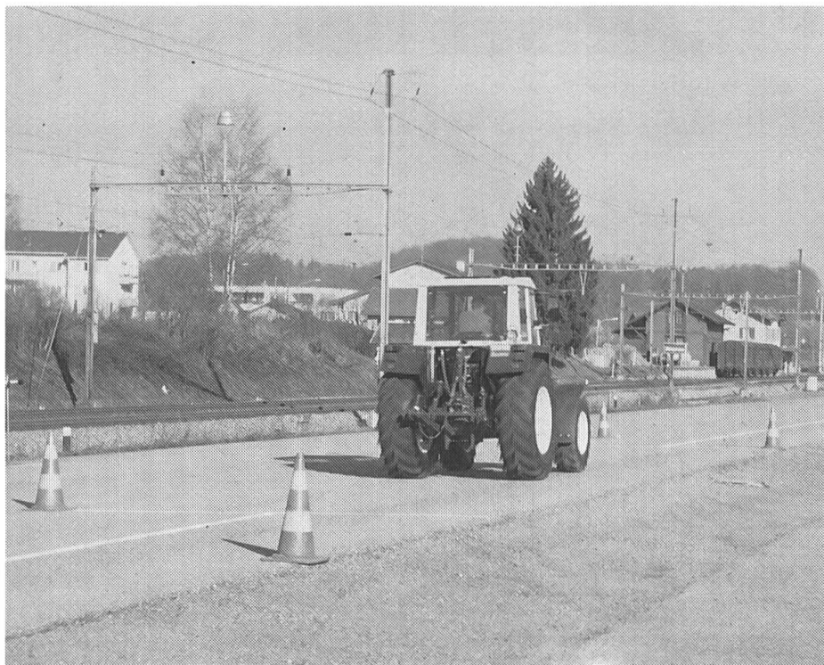
Fig. 3: Le Steyr 8090 n'a eu aucun problème au niveau du bruit. Le bruit du véhicule passant est enregistré à l'aide de microphone entre les pyramides de marquage et...
