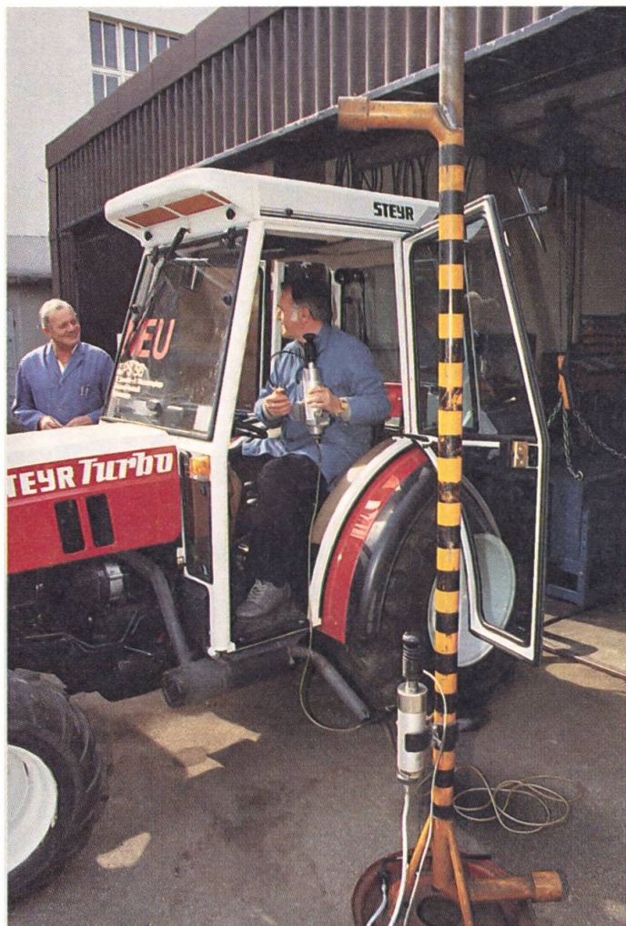
Fig. 1: Les mesurages des gaz d'échappement constituent un élément important de l'expertise des types. (Fotos: Zw)
