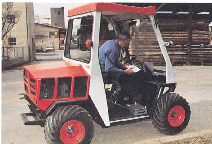
Fig. 2: Freinage total avec la MT 200. L'appareil de mesure caractérise la décélération de freinage par des courbes.
