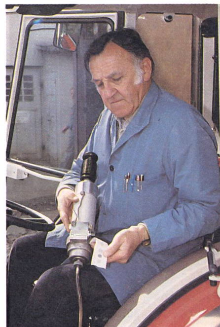
Fig 9: Pour le mesurage des gaz d'échappement en accélération libre (d'après Bacharach), on accélère le moteur à vide, du ralenti au régime nominal en actionnant la pédale des gaz. Les surfaces de filtre noircies (1,1 cm 2 ) sont estimées à l'œil en comparaison avec l'échelle de formation de suie de Bacharach.
