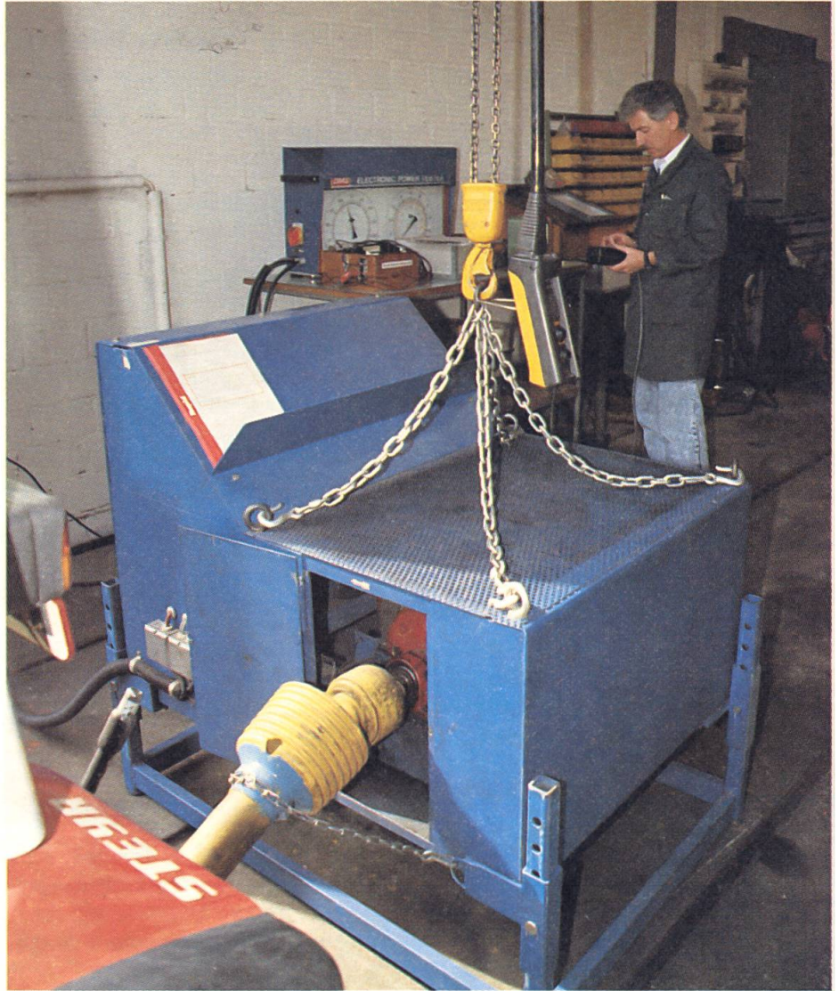
Fig. 5: Pour le mesurage des gaz d'échappement sous pleine charge (selon Bosch), le régime du moteur est modifié par les freins de prise de force.
