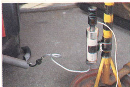
Fig. 7: La tête de mesure doit être placée aussi profondément que possible dans le tuyau d'échappement. Dans la pompe d'alimentation Bosch, 330 cm 3 des gaz d'échappement non dilués sont conduits à travers des rondelles de filtre (surface des filtres de 8 cm 2 ).
