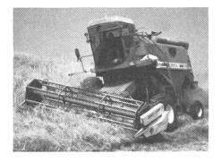
lités de la gamme Laverda est, entre autres, la 3550 AL. Elle est la seule véritable moissonneuse-batteuse pour la pente avec mise à niveau. La mise à niveau entièrement automatique aussi bien dans le sens longitudinal que latéral fait de la 3550 AL la machine la plus sûre pour le travail dans les pentes.
