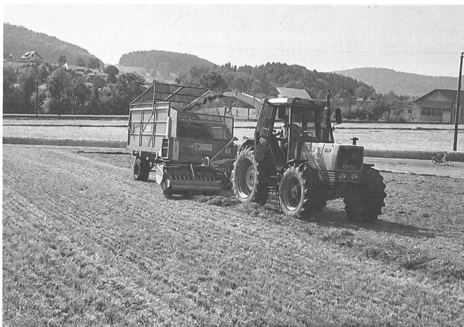
Les récolteuses-hacheuses nécessitent pour un bon rendement de surface des tracteurs à grande puissance sur la prise de force et un bon échelonnement des vitesses.
