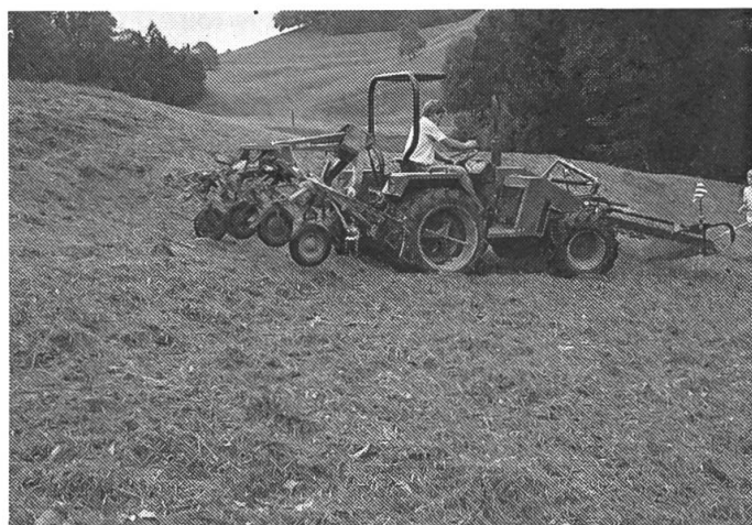
Fig. 6: Les tracteurs modifiés se distinguent avant tout par le capot bas qui permet de mieux observer les outils frontaux. La charge accrue sur l'essieu avant (outils frontaux, pneus «terra») exige en général des éléments d'entraînement renforcés.
