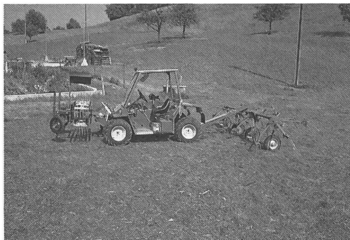
Fig. 3: Les faucheuses plutôt faiblement dimensionnées s'utilisent souvent dans des exploitations où le pourcentage de terrains en pente est élevé. Les principaux outils attelés (outre la barre de coupe): le râteau-faneur et la pirouette. Avec ce petit genre de machines, la pirouette tractée est préférable (pour des raisons de sécurité).
