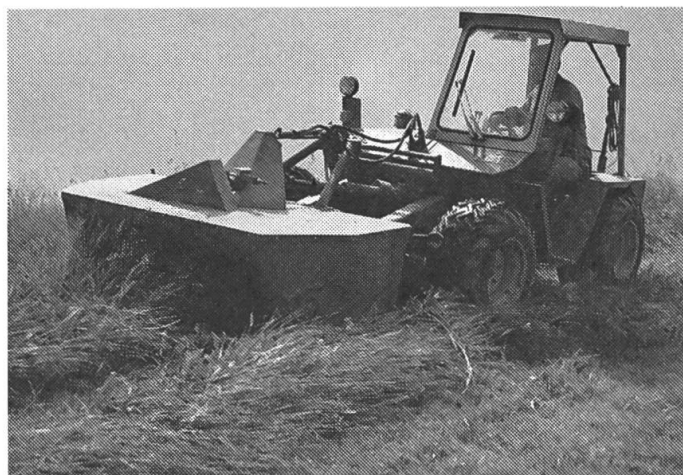
Fig. 5: Les grandes faucheuses à deux essieux présentent une relation impeccable entre la puissance du moteur et le poids à vide. C'est pourquoi elles sont appropriées aux terrains déclives, performantes et également utilisables pour des travaux légers sur les champs (faible formation de traces).
