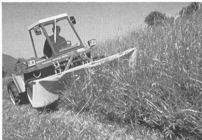
Fig. 4: La puissance du moteur des faucheuses à deux essieux moyennes suffit pour entraîner une faucheuse rotative. Le domaine d'application de ces machines, avec dispositif arrière 3-points, est très varié.
