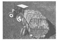
L'essieu à roues motrices et directrices peut s'adapter à toutes les autochargeuses classiques. Dans ce cas, seul le problème du ramassage du fourrage se trouve résolu.
