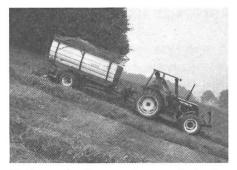
Cette exécution peut recevoir toutes les superstructures normalisées: agrégat autochargeur, citerne à pression, épandeur à fumier, pont fixe.
