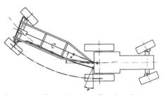
La nouvelle technique Bucher-Letran. Les roues de la remorque suivent parfaitement les traces des roues du tracteur grâce à la technique brevetée de Letran.
