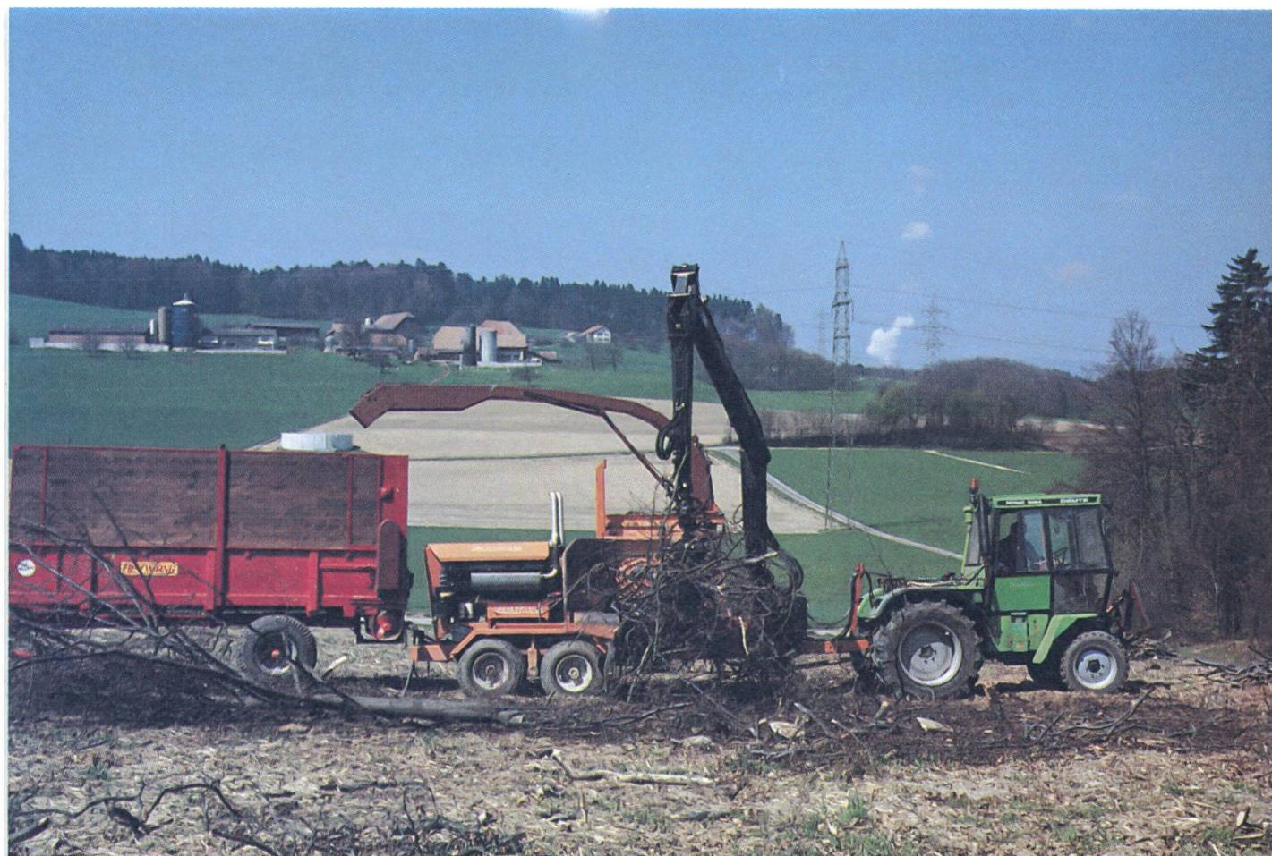
bloquer ou même endommager les vis d'Archimède d'alimentation. Les déchiqueteuses bon marché fonctionnent en général avec des disques et les plus chères avec des tambours de déchiquetage. C'est surtout avec les déchiqueteuses à disques qu'il faut veiller à ce que la dimension des plaquettes soit aussi régulière que possible, sans extrémités non déchiquetées.
