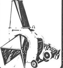
**Installation de séchage du foin, système radial.**
