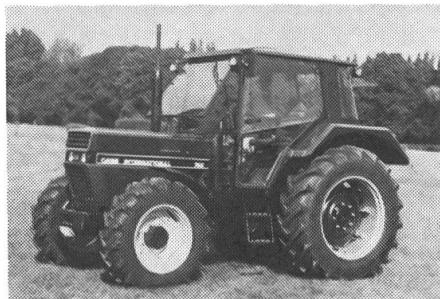
Beaucoup d'agriculteurs doivent se priver d'une cabine confort dû à la hauteur totale. CASE-IH a résolu ce problème avec l'introduction d'une version basse de la cabine confort XL. Elle est 22 cm plus basse que la version normale. Les ingénieurs ont réalisé cette solution sans aucune perte de confort. La cabine basse offre également la technique XL comme par exemple l'entraînement quatre-roues-motrices électro-hydraulique, Sens-o-draulic etc.
