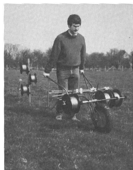
La société Früh-Maschinenbau AG, Münchwilen, lance sur le marché un nouvel appareil pour l'installation des clôtures électriques. Jusqu'à quatre fils peuvent être enroulés ou déroulés en même temps. Un accouplement patinant assure la tension uniforme du fil.
