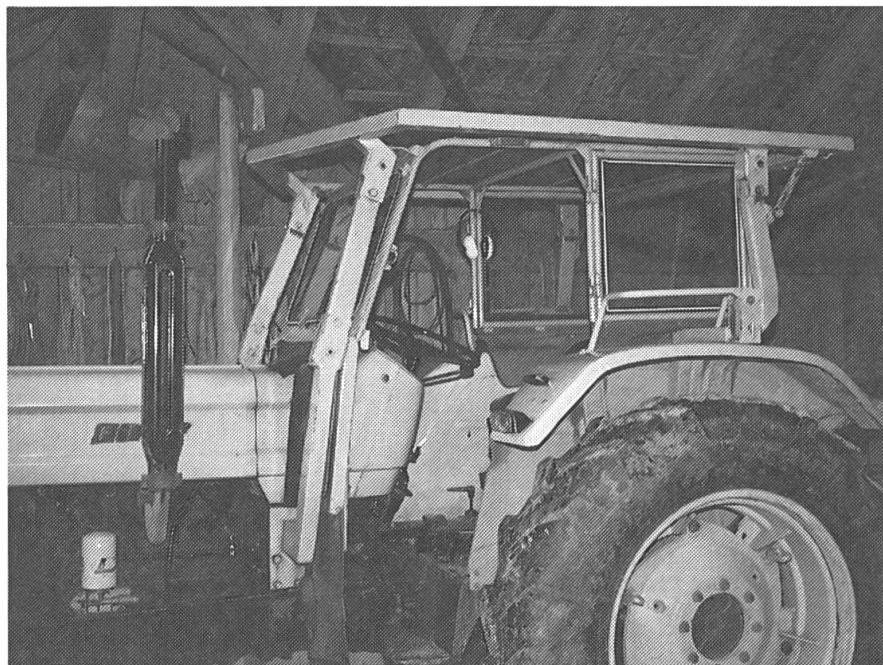
A côté de la protection contre le vent et les intempéries, la fonction de protection de cadres et d'arceaux de sécurité ou de cabines est indiscutable. Le dispositif de protection pour le conducteur diminue dans le cas d'un retournement de tracteur de manière frappante le risque d'accident. Il devrait donc être partie intégrante de la construction, donc protéger le père ou la mère et aller de soi.
