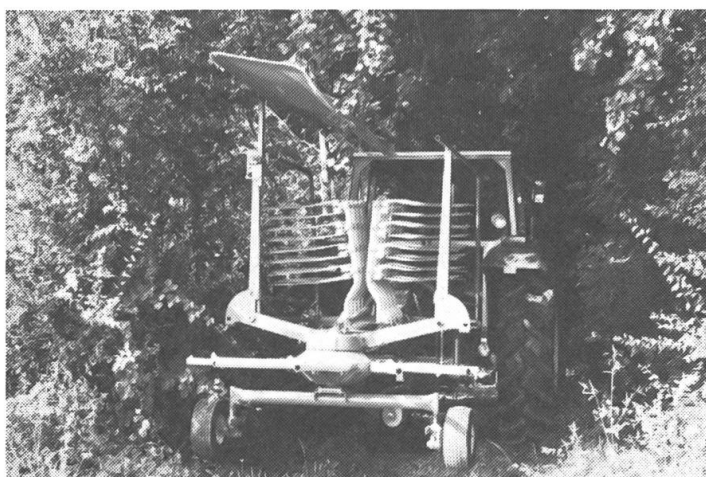
Fig. 6: Grâce aux bras de toupie amovibles, les passages étroits et le remisage ne posent pas de problème. L'endroit et le système de fixation des bras sur la machine influencent considérablement la durée nécessaire au montage et démontage.
