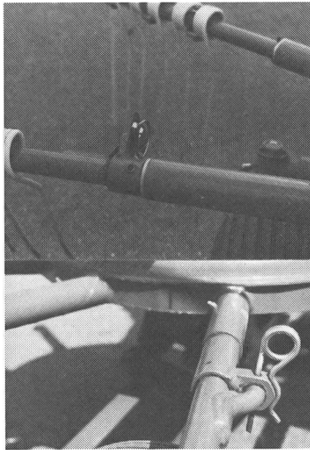
Fig. 7: Pour arrêter les bras, les goupilles rabattables conviennent nettement mieux que les goupilles de retenue à ressort.
