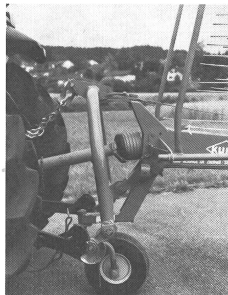
Fig. 5: Personnel sans expérience? La roue-support permet l'utilisation sans problème de l'andaineur même par les employés inexpérimentés.
