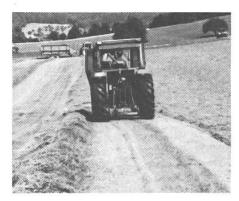
Fig. 4: L'attelage frontal est une solution convaincante sur le champ; sur la route, il contrevient à la loi.
