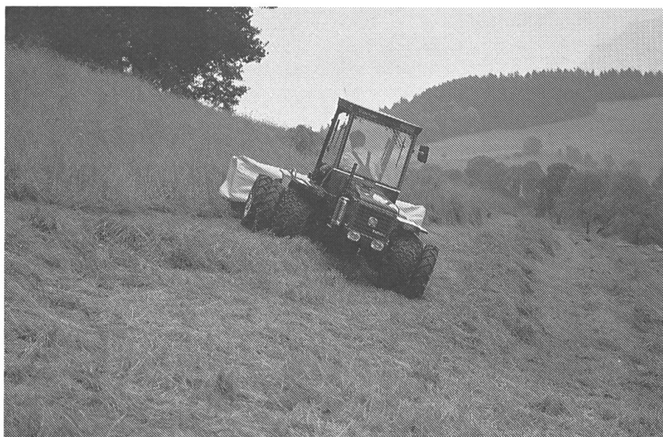
Bon parcours pour le tracteur CARRARO, équipé du poste de pilotage inverse. La trajectoire oblique par rapport à l'axe de l'andain est inévitable car, lors du travail, la direction se trouve agir sur l'axe arrière.
