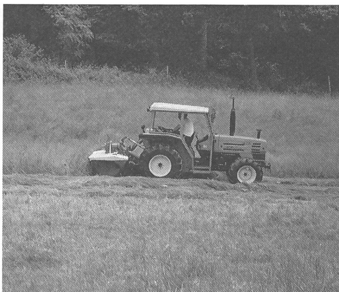
Une construction nouvelle HÜRLIMANN: boîte à vitesse réversible et poste de pilotage inverse. Elle ne montra pourtant que peu d'avantages lors de la démonstration lucernoise.
