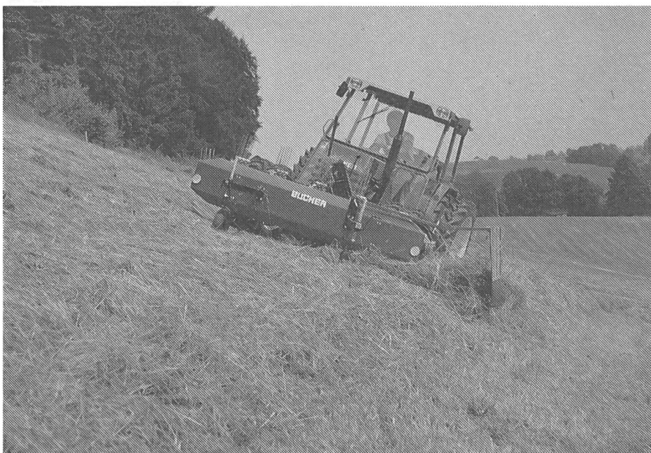
Le râtelier andaineur, disponible en plusieurs dimensions (sur la photo, combiné à un POLYTRAC de BUCHER), est une alternative tout à fait valable à l'andaineur rotatif.
