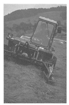
Le travail est particulièrement satisfaisant avec une faucheuse à deux essieux équipée d'une barre BUSATIS. Avec ce véhicule, il a fallu aussi corriger constamment la direction pour maintenir la trajectoire dans l'axe de l'andain.
