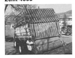
Les deux nouveaux agrégats autochargeurs Bucher LG 303-H (exécution longue) et LG 263-H présentent l'avantage d'un dispositif de coupe à 10 couteaux. L'exécution de base comprend des superstructures pour fourrage vert et sec, des parois latérales en tôle profilée zinguée et plastifiée, un dispositif de coupe pour 10 couteaux, un entraînement hydraulique du tapis, un relevage hydraulique du pick-up, un arbre à cardans avec sécurité et protection, deux béquilles et l'éclairage.
