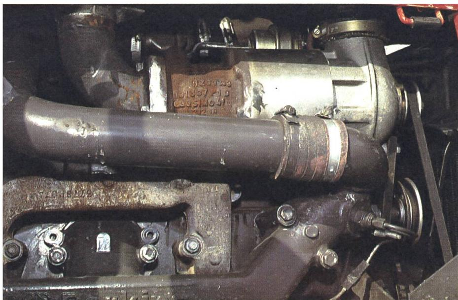
*Le COMPREX est monté sur le collecteur d'échappement. Le rotor est actionné par une courroie d'entraînement. Par régime élevé, une soupape dont on peut apercevoir la commande au centre, près du bord supérieur de l'illustration, modère la pression de la charge.*
