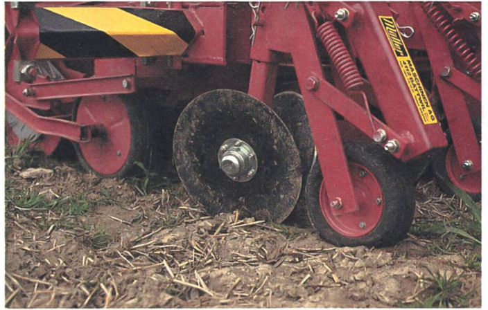
Les disques écarteurs avec roue de jauge placés devant l'agréat semeur d'un semoir monograine usuel, permettent un semis direct sans bourrages.
