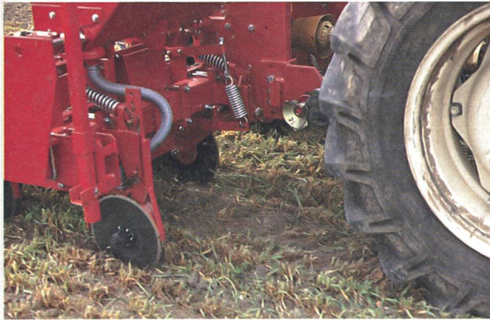
Avec un semoir spécial, il n'y a pas de problème à exécuter un semis direct dans le seigle fourrager déjà récolté préalablement.
