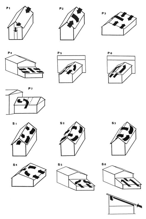
Fig. 10: Au moment de la planification, le guidage de l'air joue un role important. Selon la conception du bâtiment, il faudra prévoir des guidages qui sont chaque fois à vérifier. La variante «P» correspond à des toits à pannes, la variante «S» à des toits à chevrons.
