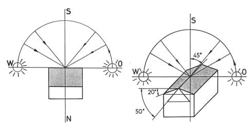
Fig. 3: Selon la pente et l'exposition du toit (exposition par rapport au soleil) il est possible d'utiliser une part plus ou moins grande du rayonnement solaire. La meilleure exposition est vers le sud, avec une inclinaison de 20°. Mais des toits exposés vers l'est ou vers l'ouest peuvent encore donner 70 – 90% de cette part.
