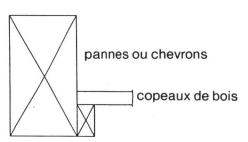
Grosses poutres, petit passage nécessaire. La plaque de copeaux de bois repose sur une latte latérale. Placé par le haut, avant de recouvrir le toit.
