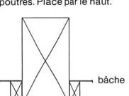
De grosses poutres, passage nécessaire plutôt petit. La bâche est fixée latéralement sur les lattes.
