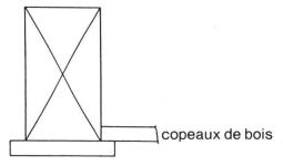
Le passage nécessaire est légèrement plus petit que l'épaisseur des poutres. Placé par le haut.
