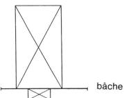
La hauteur des poutres correspond au passage nécessaire. Dans ce cas on a utilisé une bâche. Se prête particulièrement bien pour les toits à chevrons et dans de vieilles constructions.
