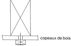
La hauteur des poutres correspond au passage nécessaire. La plaque de copeaux de bois est reliée à la latte.
