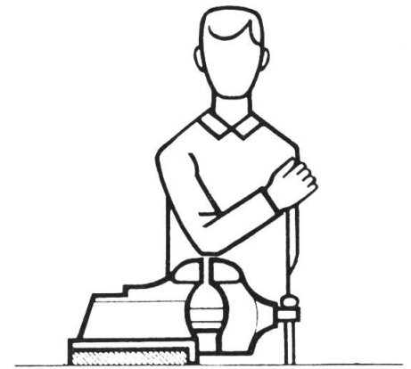
Fig. 3: Hauteur correcte de l'étau.
