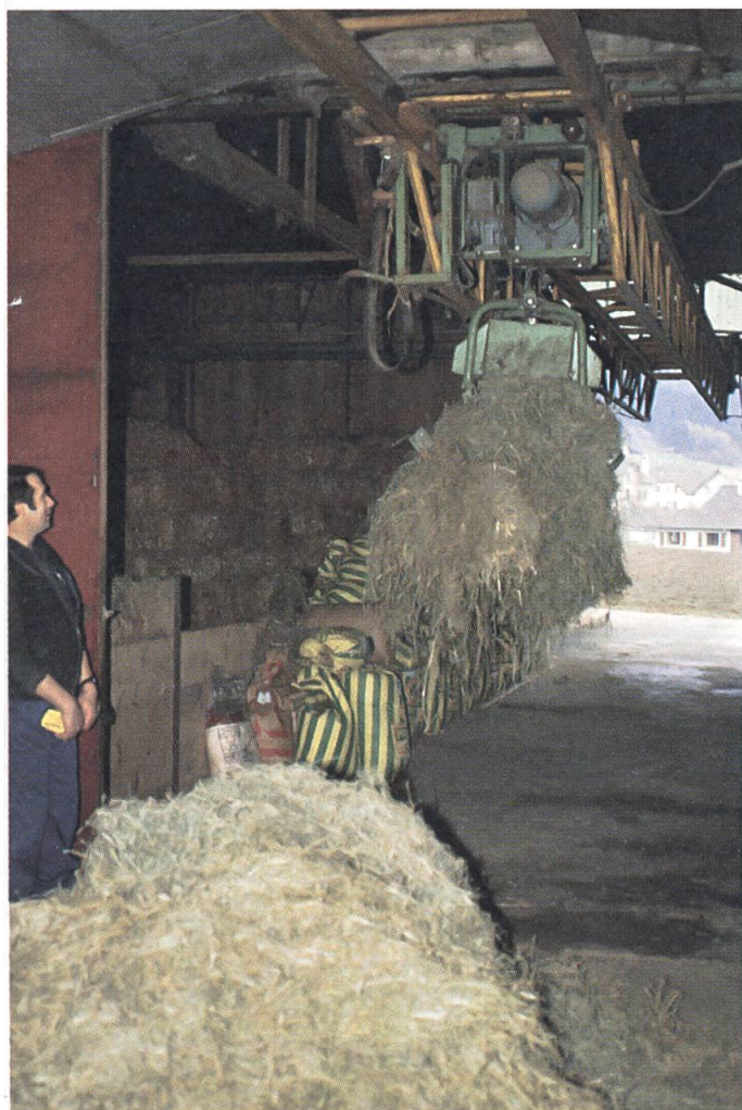
J.-M. Mossey, Cernier, a solutionné le problème de transport sur l'exploitation avec une griffe qui peut être avancée dans le couloir d'affouragement.
