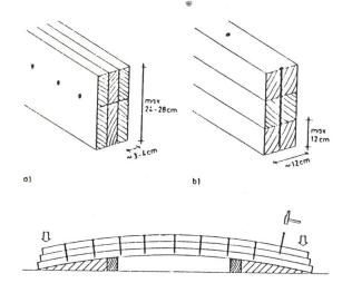
a) rigidité totale; b) rigidité diminuée par la flexion antérieure du moyen d'assemblage; c) compensation des fortes déformations par «rehaussement» avant l'assemblage.
