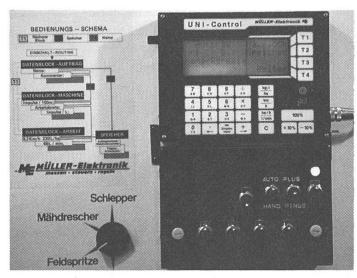
Ordinateur de bord «Uni-Control» permettant d'assister le pilotage et la surveillance. L'entrepreneur peut en retirer les données nécessaires aux calculations et, dans un délai plus ou moins proche, il sera possible de les transférer directement à l'ordinateur domestique.
