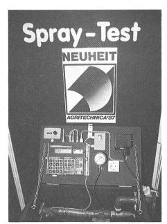
Spraytest permettant la simplification des tests de pulvérisation. Ainsi, il devrait être possible de mesurer tous les paramètres relatifs au pulvérisateur, sur la base de l'observation du diagramme de pulvérisation et de la répartition du liquide pulvérisé et respectivement de les ajuster à la vitesse d'avancement et à la largeur de la barre choisie. Il n'est par contre pas possible de mesurer la répartition du brouillard de pulvérisation en fonction du type de buse utilisé.
