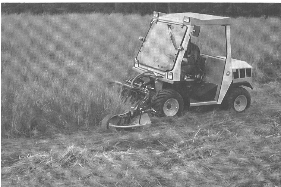
La motofaucheuse MT 200 est équipée de quatre pneus Terra identiques à basse pression.
