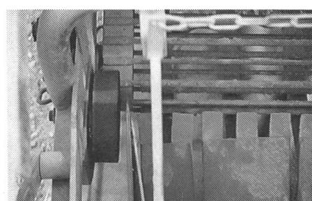
La pression des rouleaux à fanes sur les tapis de tamisage doit être suffisante. Il faut aussi vérifier que le tapis de tamisage avance bien régulièrement de part et d'autre des axes de rotation; si cela n'était pas les cas, il doit être recentré en ajustant la tension du côté correspondant. La fixation des tringles du tapis de tamisages doit aussi être contrôlée.
