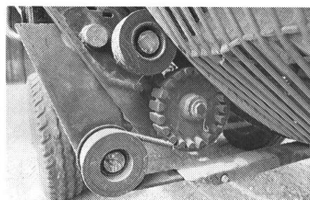
Le parfait fonctionnement de l'entraînement de la roue d'élévation doit être vérifié: il faut contrôler la tension des courroies d'entraînement ainsi que le réglage de l'embrayage. Les matrices de caoutchouc de la roue d'élévation doivent être remplacées au besoin et les joints de matière synthétique resserrés. Il est nécessaire de s'assurer aussi du bon fonctionnement de l'installation de séparation des fanes et d'y remplacer les doigts manquant.
