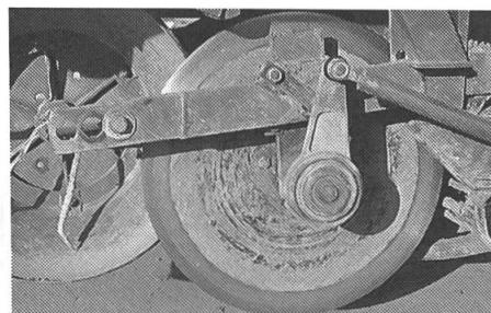
Le rouleau de guidage doit être ajusté de façon à ce qu'il reste relativement libre, mais il faut vérifier qu'il n'ait pas trop de jeu latéral. Les disques doivent être réglées selon les instructions du fabricant; lors de cette opération, il faut bien prendre garde de respecter les distances entre les disques et le soc d'arrachage ainsi qu'entre les disques et le tapis de tamisage. S'il y a beaucoup de mauvaises herbes, il convient d'aiguiser aussi les disques.
