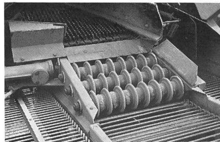
Les éventuelles défectuosités des bandes de séparation et du tapis de tamisage doivent être détectées; leur tension doit être correctement réglée. Il faut aussi veiller à la bonne tension des bandes afin que leur mouvement soit bien centré. Les brosses de séparation doivent être régulièrement nettoyées des fanes qui s'y enroulent afin que leur fonction de séparation reste assurée.
