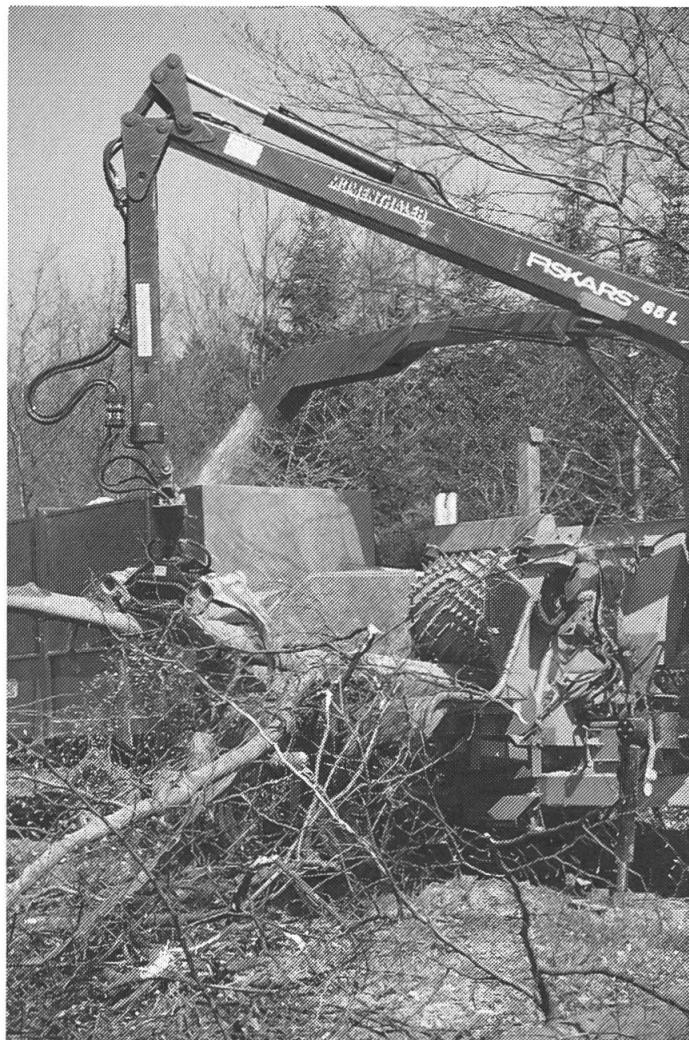
*La transformation d'arbres entiers n'est possible qu'en combinant une hacheuse à grande capacité et grande ouverture d'alimentation avec une grue à bois.*
