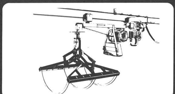
Voici la première griffe à fourrages commandée électriquement pour la préparation du fourrage. Une seule pression sur un bouton et vous transportez le fourrage désiré. Sans changer de place et par simple réglage, vous pouvez choisir 4 postes de chargement sur le tas (sur la meule) et jusqu'à 15 postes de déchargement automatiques. Grâce à un nouveau système d' entraînement, des élévations de 30° (52%) ne posent aucun problème. C'est bien entendu une nouveauté Zumstein!
