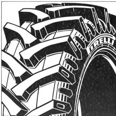
Le nouveau profil des TM-190 avec crampons spéciaux.
