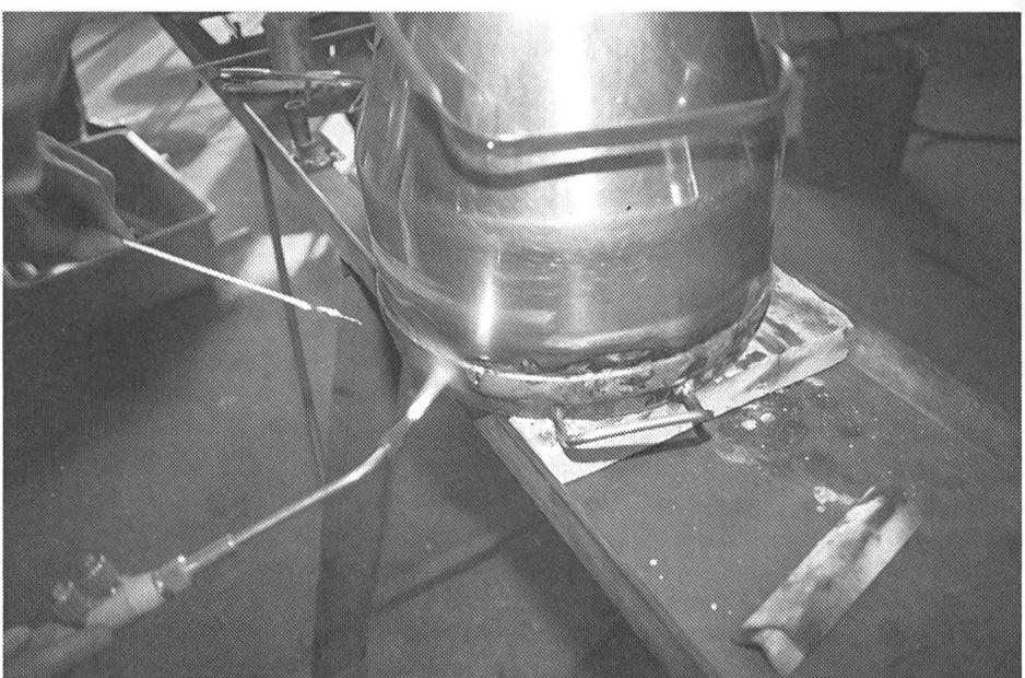
*Avec le procédé de pluvérisation au pistolet, il est possible d'appliquer sans dommage des couches de métal résistantes à l'usure sur des arêtes ou des lames minces (soccs, couteaux etc.). La poudre de métal se prête à plusieurs usages. Pour l'atelier de la ferme, ce prodédé peut être intéressant là, où les parties enduites ou recouvertes ne nécessitent plus de travail subséquent.*
