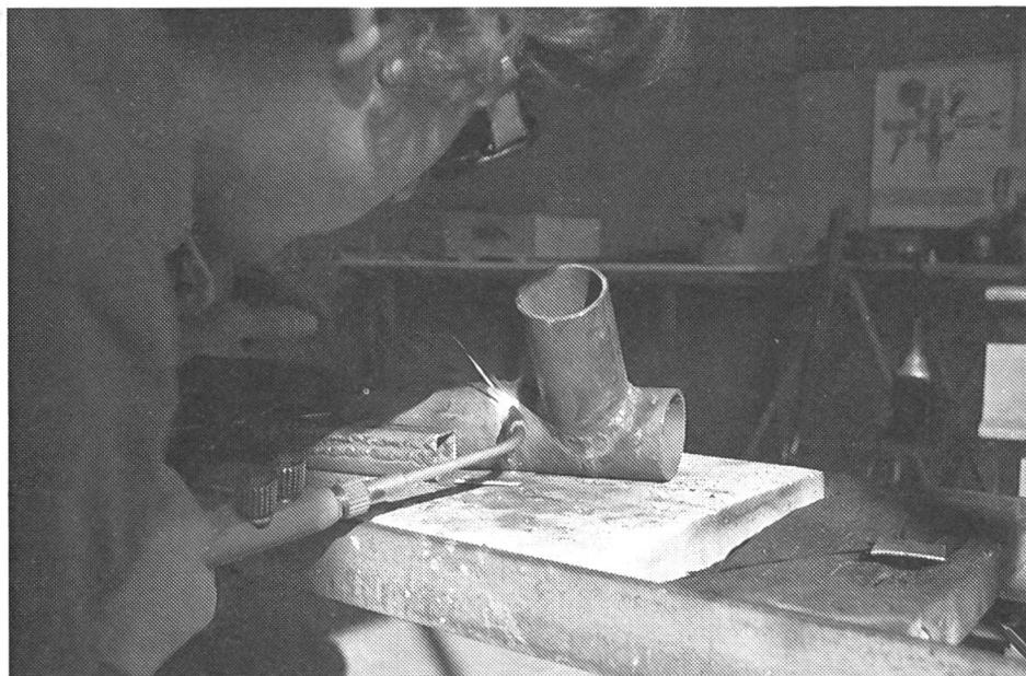
Pour souder des tuyaux d'acier, la taille du chalumeau coupeur dépendra de l'épaisseur de la paroi du tuyau. On choisit le diamètre du fil soudeur selon la formule:  $1/2$  épaisseur de métal (épaisseur de la paroi) + 0,5 mm. Attention: Danger d'explosion avec les gaz qui s'écoulent en bout de tuyau, ils peuvent produire des flammes subites.
