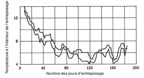
Fig. 3: Progression de la température à l'intérieur de l'entreposage. Courbe supérieure: progression pour betteraves placées à 90 cm du sol. Courbe inférieure: progression pour betteraves placées à 40 cm du sol.
