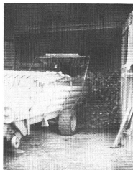
Fig. 6: Pour l'entreposage dans des granges dont les portes sont plutôt basses, il vaut mieux travailler avec des chars à fond mouvant qu'avec des remorques basculantes.
