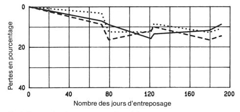
Fig. 2: Progression des pertes en matière sèche.
