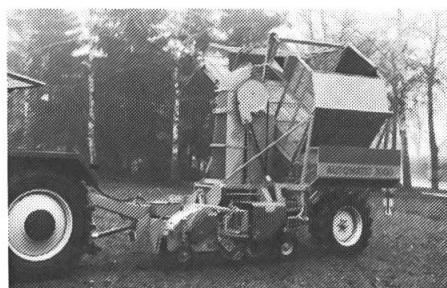
une nouvelle arracheuse-récolteuse de betteraves deux rangs. Cette nouvelle arracheuse-décolleteuse-récolteuse type V 202 a été mise au point dans le but d'offrir une machine avantageuse à plusieurs rangs. La V 202 est, avec un poids opérationnel de 3,7 t, des pneumatiques 500–26,5 12 PR ménageant le sol, particulièrement facile à conduire et déjà utilisable avec des tracteurs à partir de 75 CV. Sa capacité de trémie est de 5000 kg. La hauteur de déversement, avec ses 3,75 m, est
