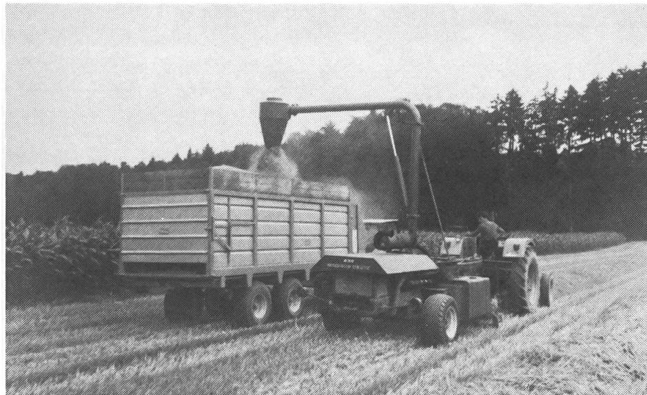
assez exactement sur le nombre de tours initial nécessaire de 2200 tours. Le démarreur, un installation électrique et un réservoir à carburant (la consommation de diesel atteint environ 30 litres par heure) complètent ensemble avec le filtre à air cette unité d'entraînement. Depuis le tracteur et par au moyen d'un accouplement hydraulique, le moteur peut d'autre part être séparé de l'arbre à cardan, qui transmet la force sur le moulin
