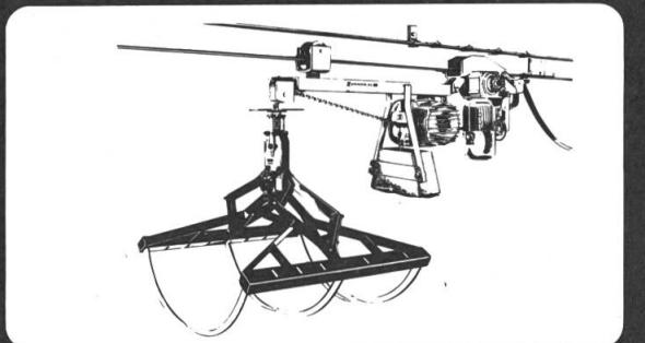
Voici la première griffe à fourrages commandée électriquement pour la préparation du fourrage. Une seule pression sur un bouton et vous transportez le fourrage désiré. Sans changer de place et par simple réglage, vous pouvez choisir 4 postes de chargement sur le tas (sur la meule) et jusqu'à 15 postes de décharge automatiques. Grâce à un nouveau système d'entraînement, des élévations de 30° (52%) ne posent aucun problème. C'est bien entendu une nouveauté Zumstein!
