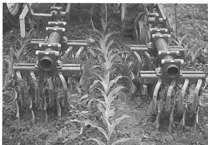
Fig 8: La sarcleuse Haruwy avec dents d'ameublissement et soleils en forme de bêches a donné une très bonne qualité de travail, même par conditions très difficiles. Pour le travail de butage, il faut changer les soleils.
