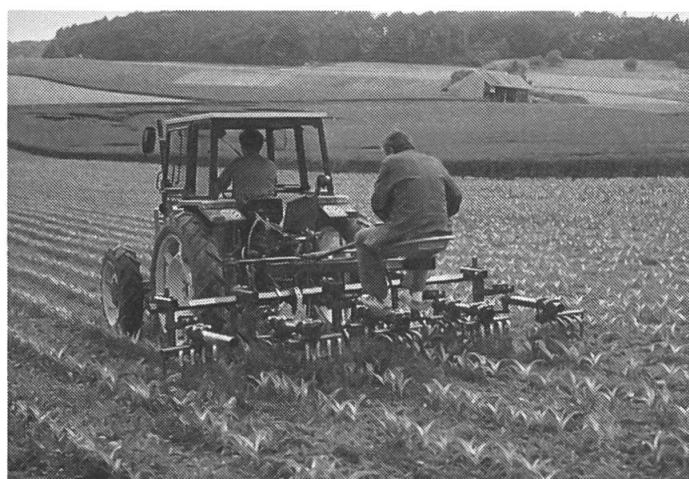
Fig 8: La sarcleuse Haruwy avec dents d'ameublissement et soleils en forme de bêches a donné une très bonne qualité de travail, même par conditions très difficiles. Pour le travail de butage, il faut changer les soleils.
