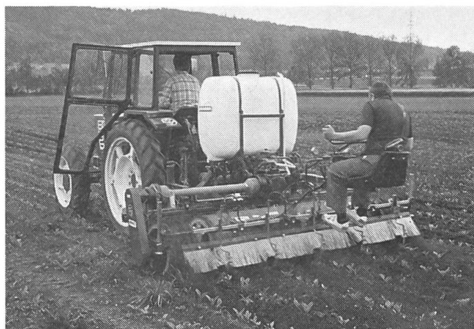
Fig. 5.: La brosse sarcleuse (Bärtschi) a donné de bons résultats dans les cultures de légumes. Pour les cultures de betteraves, certaines améliorations devraient être faites pour ce qui est de la prise des mauvaises herbes dans les traces du tracteur, du réglage de la largeur du tunnel de protection et de la protection de la poussière (pulvérisateur Birchmeier).
