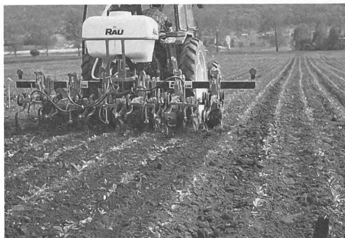
Fig. 1: En plaine, le sarclage combiné avec une pulvérisation d'herbicide peut se faire avec un seul homme (Rau). Les avantages: Trois socs sur supports à ressorts, broche réglable. Ce système peut être également utilisé dans les cultures de maïs. (Il existe un cadre de moins de 3 m).
