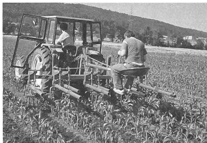
Fig. 7: L'intensité de travail peut être réglée par la position oblique des sarclieuses-soleil. Les soleils taillés en forme de cône, de façon symétrique sont simplement tournés pour le travail de butage. Pour un travail dans un sol dur, il faut utiliser des dents d'ameublissement (Müller).
