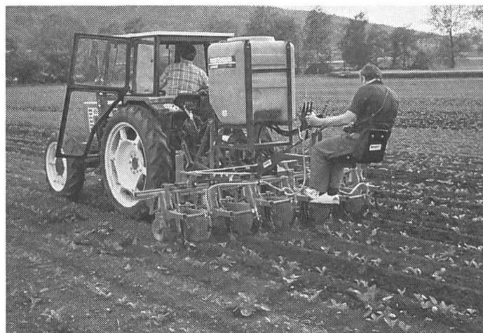
Fig. 4: Le travail avec des jeux de trois socs est meilleur qu'avec des jeux de deux socs, mais ceux-ci doivent être décalés (Bärtschi). Le pulvérisateur en lignes est en fait un pulvérisateur pour cultures basses, sans rampe (Berthoud).
