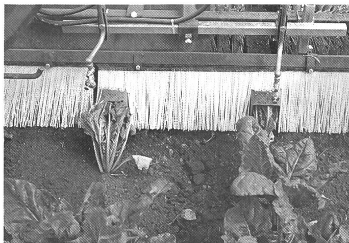
Fig. 5.: La brosse sarcleuse (Bärtschi) a donné de bons résultats dans les cultures de légumes. Pour les cultures de betteraves, certaines améliorations devraient être faites pour ce qui est de la prise des mauvaises herbes dans les traces du tracteur, du réglage de la largeur du tunnel de protection et de la protection de la poussière (pulvérisateur Birchmeier).
