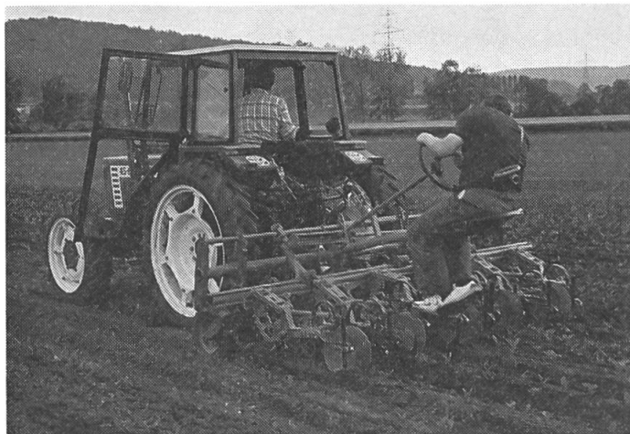
Fig. 2: La sarcleuse munie de socs à patte d'oie «Vibro», guidage parallèle a donné de bons résultats. A droite: deux passages de sarclage dans un sol minéral, les mauvaises herbes ont été éliminées.
