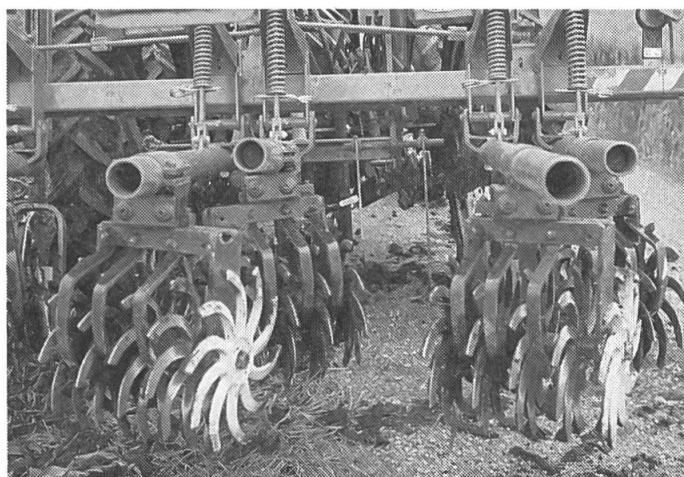
Fig. 7: L'intensité de travail peut être réglée par la position oblique des sarclieuses-soleil. Les soleils taillés en forme de cône, de façon symétrique sont simplement tournés pour le travail de butage. Pour un travail dans un sol dur, il faut utiliser des dents d'ameublissement (Müller).
