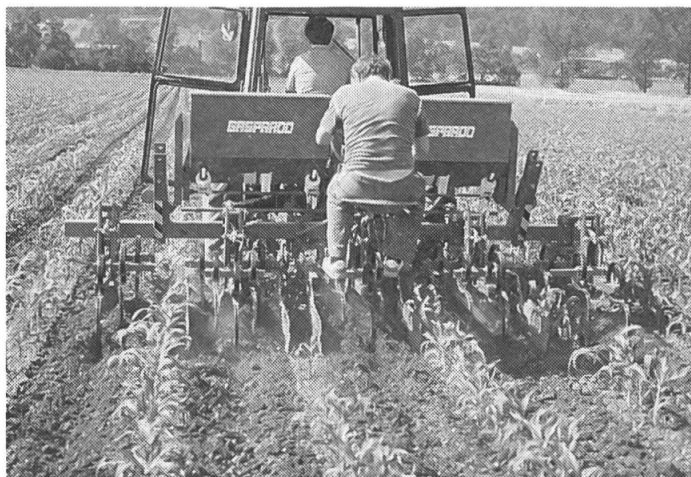
Fig. 6: La sarclieuse Gaspardo, avec un pulvérisateur d'engrais en lignes et munie de socs sarclieurs bien décalés a donné de bons résultats.
