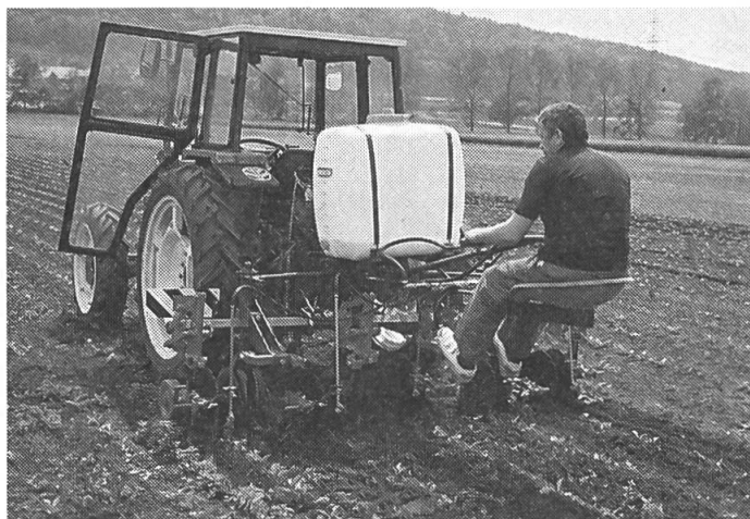
Fig. 3: Avec l'outil polyvalent Haruwy, les traces du tracteur sont bien ameublies (support rigide), mais la fixation des buses sur des supports de disque protecteur ronds n'est pas satisfaisante (pulvérisateur en lignes Fischer).
