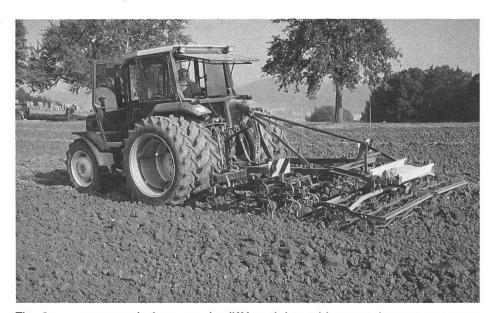
Fig. 3: ... que pour le hersage, le différentiel autobloquant du tracteur toutes roues motrices ne réalise pas de diminution de patinage particulière.
