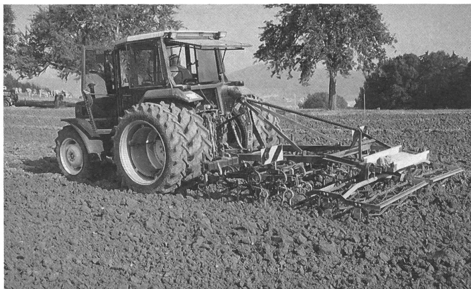
Fig. 3: ... que pour le hersage, le différentiel autobloquant du tracteur toutes roues motrices ne réalise pas de diminution de patinage particulière.
