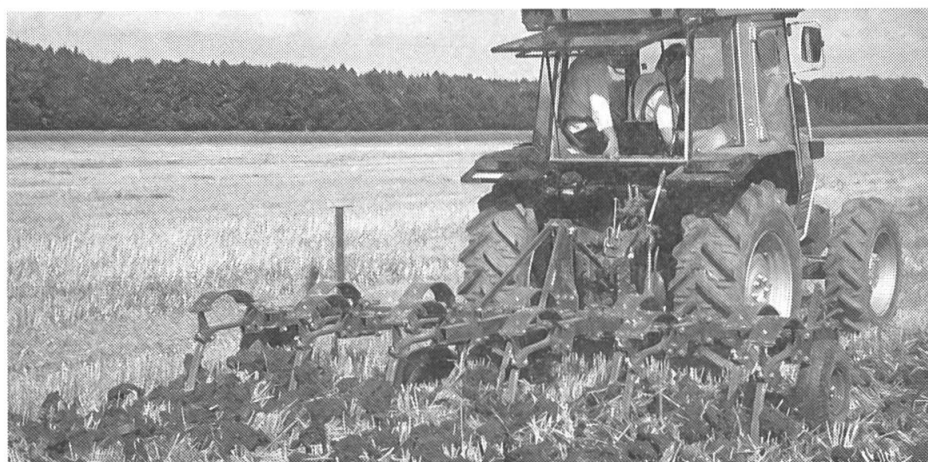
Le cultivateur avec dispositif de sécurité, non associé à une unité le suivant, crée une surface recouverte de grosses mottes.
