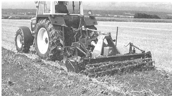
Combinaison cultivateur court-herse rotative. Lors du déchaumage aussi, le sol ne doit pas être travaillé dans un état trop humide.
