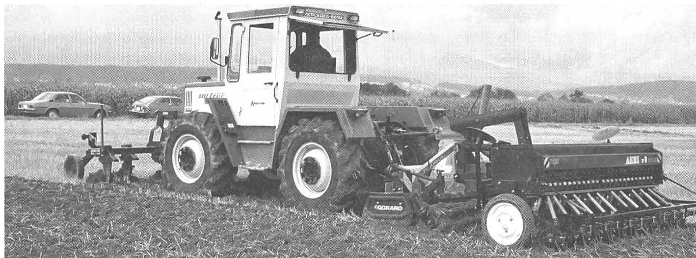
Avec cette combinaison, il est possible d'effectuer le déchaumage et le semis en un seul passage. Les tracteurs requis à cet effet sont cependant chargés au maximum.
