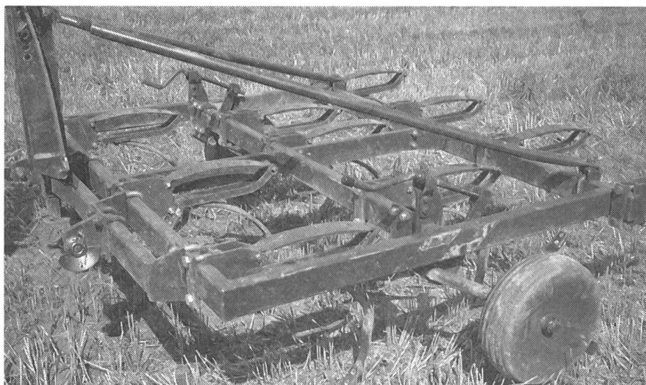
Le cultivateur-déchaumeur se prête tout particulièrement au déchaumage superficiel. Des roues-supports pour la conduite de la profondeur se sont avérées efficaces.
