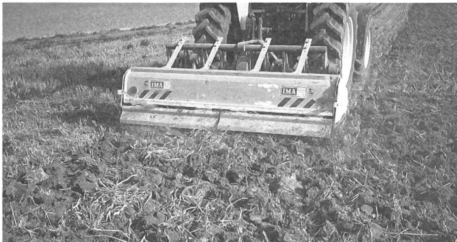
La bêcheuse permet un meilleur mélange des résidus de récolte que la charrue.
