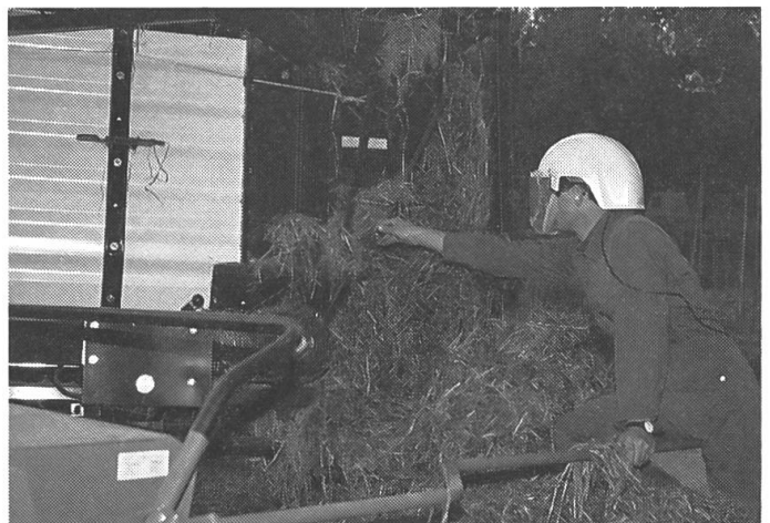
2: Le côté accessible de la table d'alimentation doit être muni d'une barrière empêchant de se retenir sur elle ou de l'enjambrer. Dans les modèles récents, celle-ci est reliée à l'arceau-interrupteur, ce qui permet d'arrêter les organes d'introduction tout au long du tapis d'amenée.
