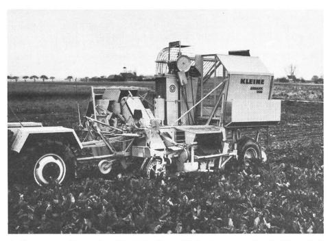
1: Dans la machine présentée ici, le dispositif d'entreposage des feuilles est situé devant la trémie, dans le champ visuel du conducteur.
