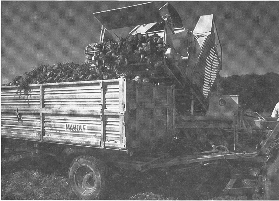
7: Pour que la remorque puisse être chargée complètement, la trémie doit être pourvue d'un long cantilever.
