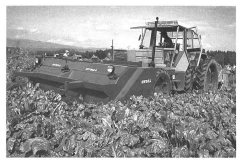
5: Décolletage et décrottage à l'avant; arrachage et dépôt en andains allongés à l'arrière.
