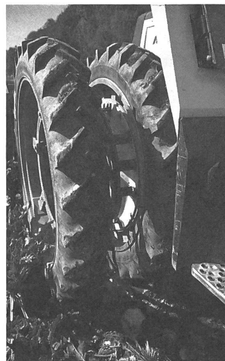
6: Les pneus jumelés spéciaux pour betteraves se sont révélés très efficaces. Un rang de betteraves se trouve entre les roues.
