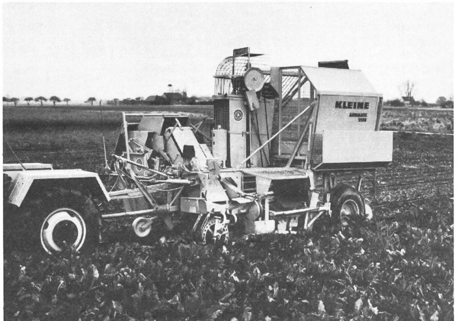
1: Dans la machine présentée ici, le dispositif d'entreposage des feuilles est situé devant la trémie, dans le champ visuel du conducteur.
