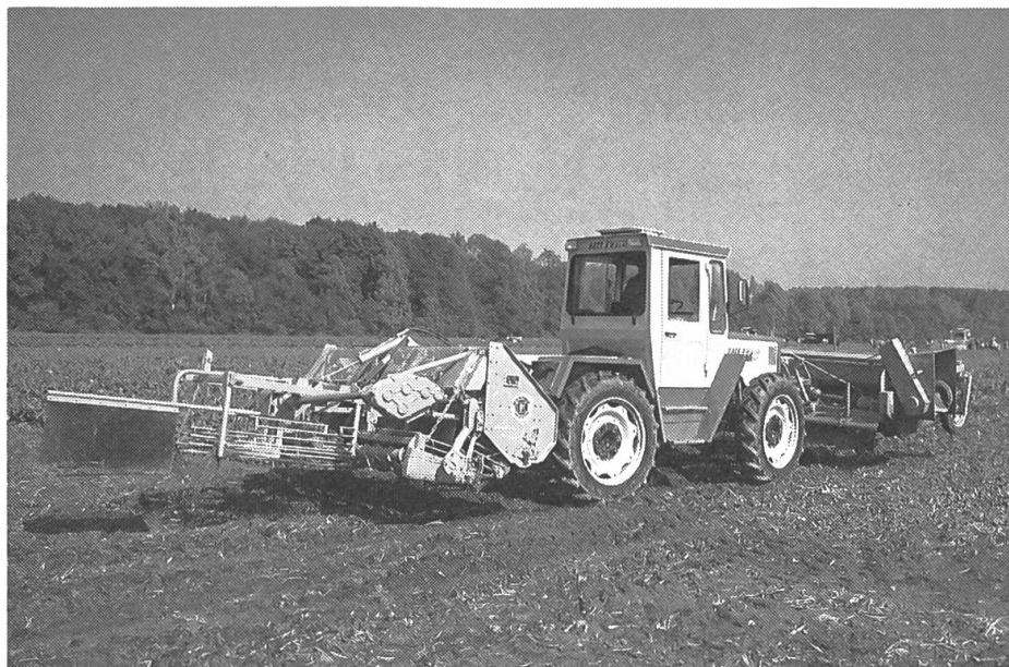
4: Les machines de récolte à 6 rangs ont reçu un élan supplémentaire grâce aux tracteurs Trac et à l'attelage frontal au tracteur standard ainsi qu'à une traction quatre roues motrices facile à manier.
