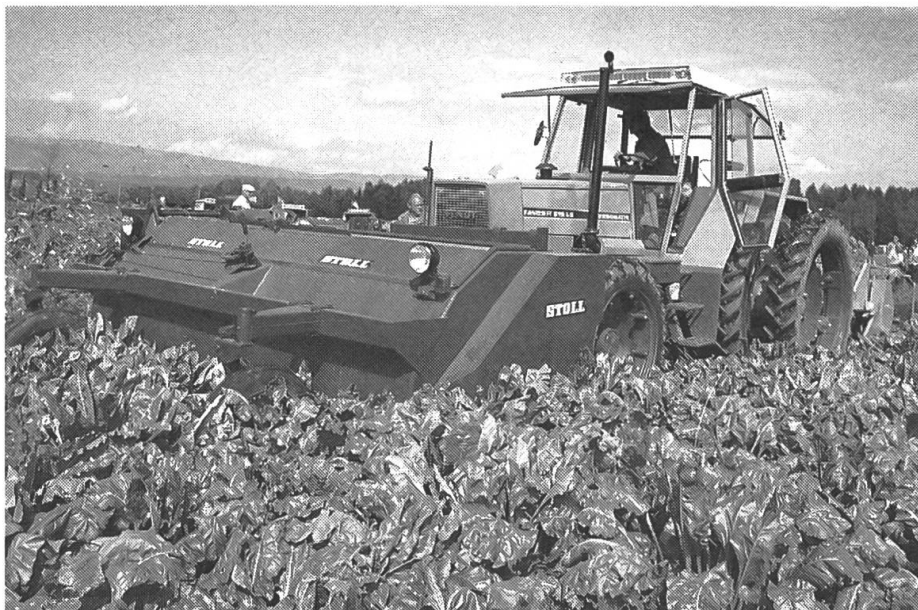
5: Décolletage et décrochage à l'avant; arrachage et dépôt en andains allongés à l'arrière.
