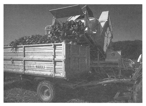
7: Pour que la remorque puisse être chargée complètement, la trémie doit être pourvue d'un long cantilever.
