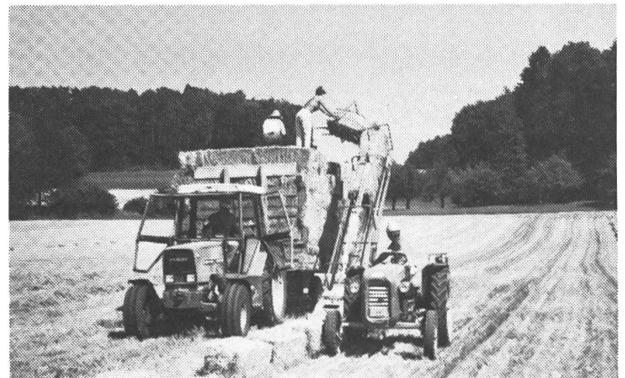
Fig. 4: Chargeur entraîné par prise de force
