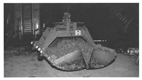
Fig. 3: Le séjour sous une charge suspendue est interdit! Il faut éloigner les personnes non autorisées de la zone d'action de la griffe à fourrage.
