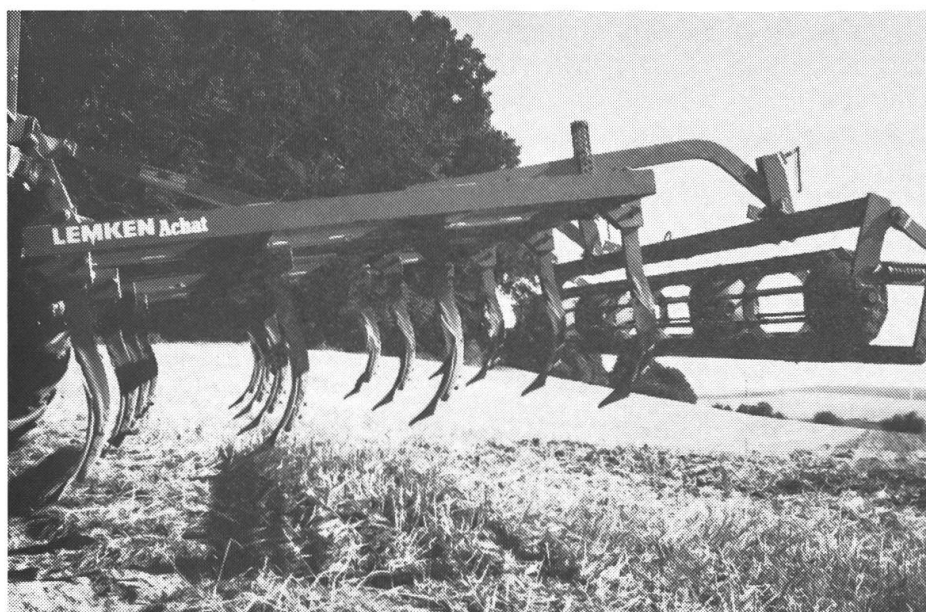
La forme cœur double du soc permet un très bon émoulement. Il est avantageux de combiner le cultivateur avec un outil traîné.
