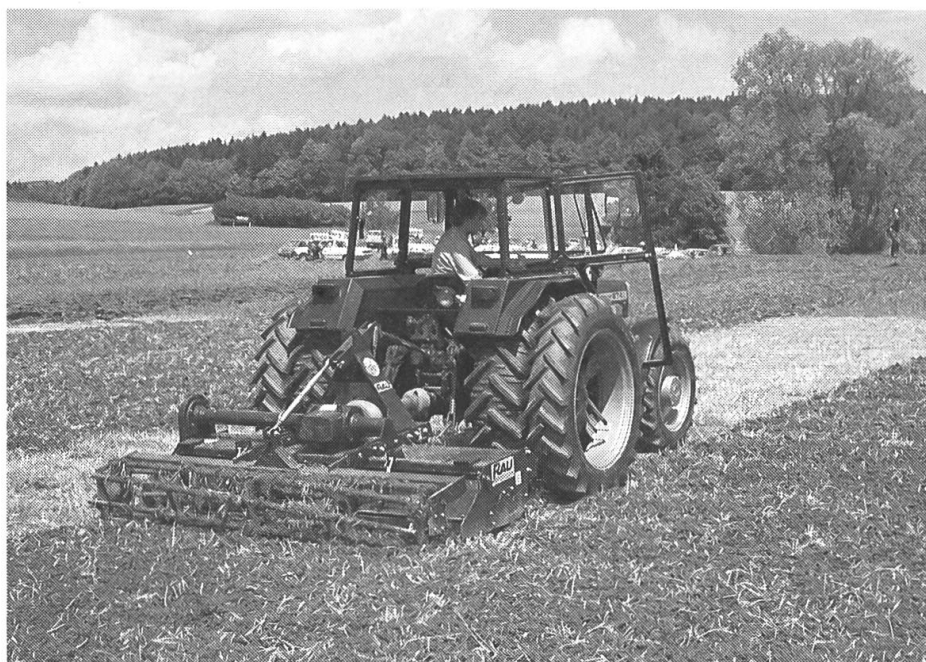
La fraise garantit un mélange optimal de terre et de résidus de paille.
