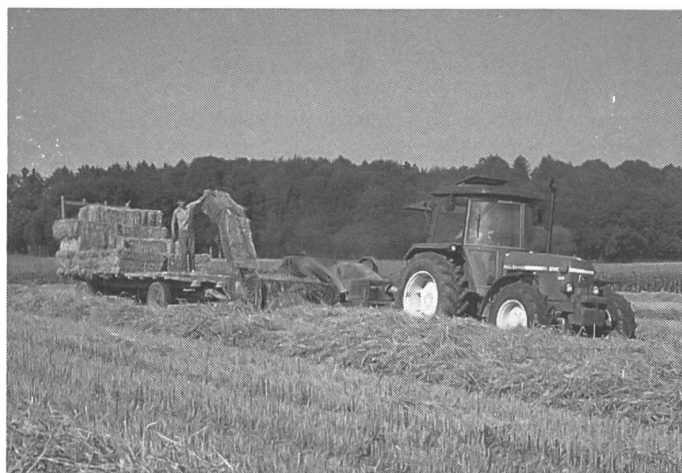
La presse avec rampe de chargement, le char étant attelé à la remorque. Ce chantier est trop lent si la récolte se fait par entreprise. Il se rencontre surtout en Suisse romande et n'est envisageable que si l'exploitant est propriétaire de la presse.
