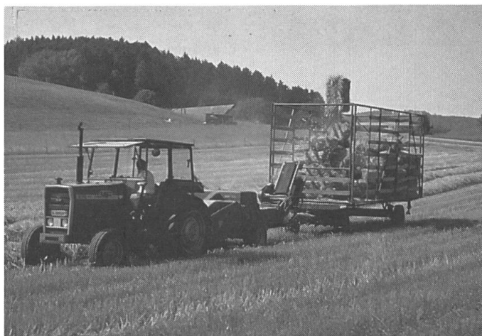
L'éjecteur de bottes, placé sur la presse ou machine individuelle, permet un chaîne entièrement mécanisée au champ.
