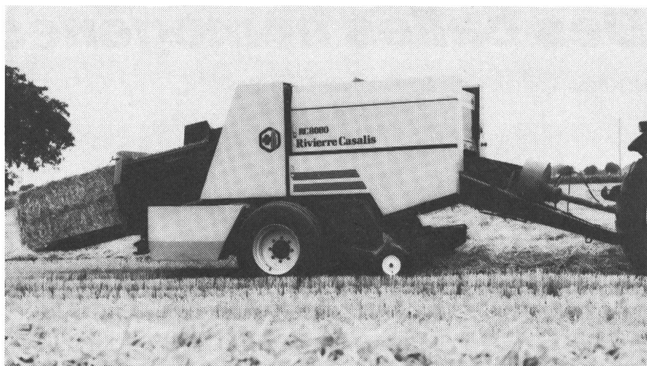
Les grandes balles rectangulaires ont une forme qui permet l'utilisation optimale de l'espace. L'approvisionnement du canal de pressage s'effectue depuis en bas.
