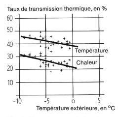
Fig. 8: Taux de transmission thermique et d'échange de température, par rapport à la température extérieure, pour l'échangeur A.
