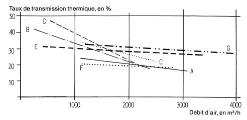
Fig. 6: Taux de transmission thermique, par rapport au débit d'air, pour les échangeurs A à G.
