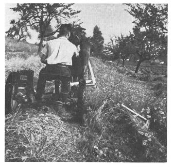
La transition de la technique des machines à traction animale à la motorisation totale a été très souple. Le mouvement de rotation mécanique a été repris par le moteur, alors que le cheval se chargeait toujours de la traction.
