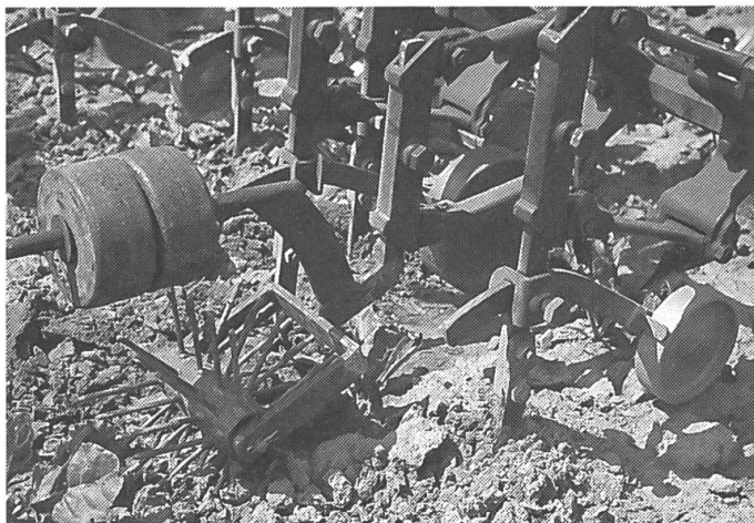
La roue à dents qui passe sur les rangs alimente les betteraves avec de l'air. La bineuse entre les lignes ne peut pas faire cela!
