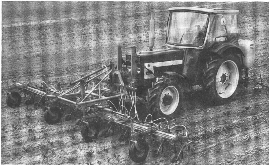
Le binage et la pulvérisation par bande effectués en une seule opération. Le manque de temps ne permet souvent pas l'application de cette méthode. On peut cependant élever les couteaux s'il faut rapidement épandre l'herbicide avant la pluie du soir.
