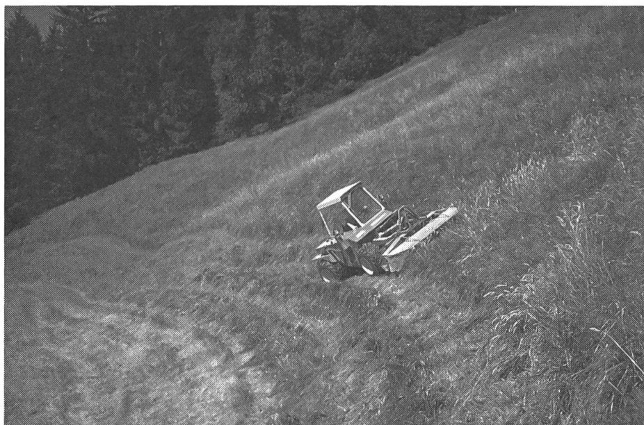
2: Les faucheuses à deux essieux sont très puissantes et à usage multiple dans les exploitations fourragères. En raison du coût élevé, néanmoins, son acquisition ne peut être justifiée que pour les grandes exploitations.
