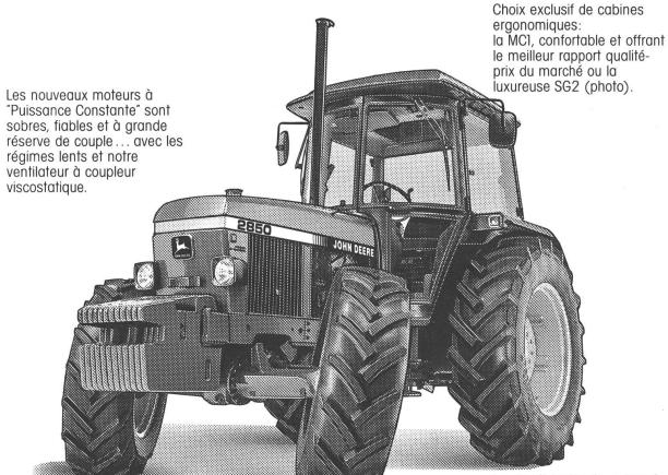
Le pont-avant mécanique, à angle de chasse exclusif de 12° permet de virer sur place, un simple bouton commande l'enclenchement avec un bout de doigt. Le robuste pont-avant est à différentiel autobloquant.
