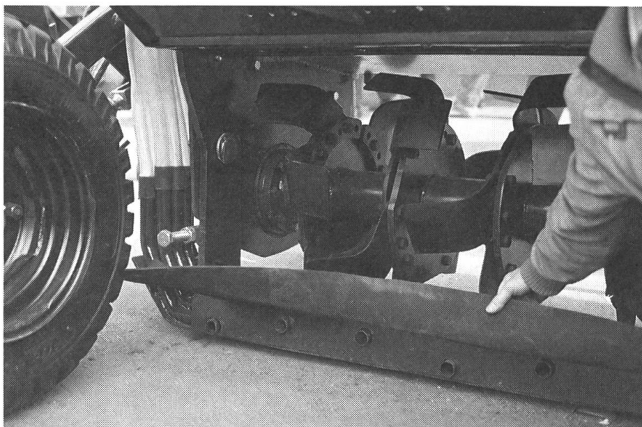
2: Avec cette combinaison fraise/semoir, livrable avec une largeur de travail à partir de 2,5 m la semence est transportée avec de l'air comprimé dans le rail à semence et déposée dans le sol travaillé par la fraise.
