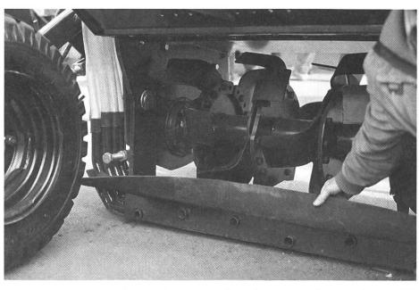
2: Avec cette combinaison fraise/semoir, livrable avec une largeur de travail à partir de 2,5 m la semence est transportée avec de l'air comprimé dans le rail à semence et déposée dans le sol travaillé par la fraise.
