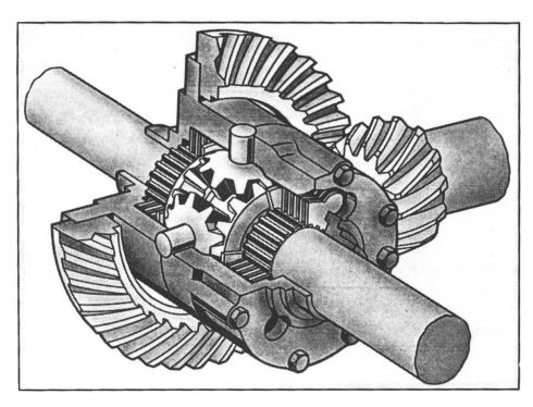
1: A charge supérieure, le différentiel auto-bloquant à lamelles augmente l'effet de bloquage.
